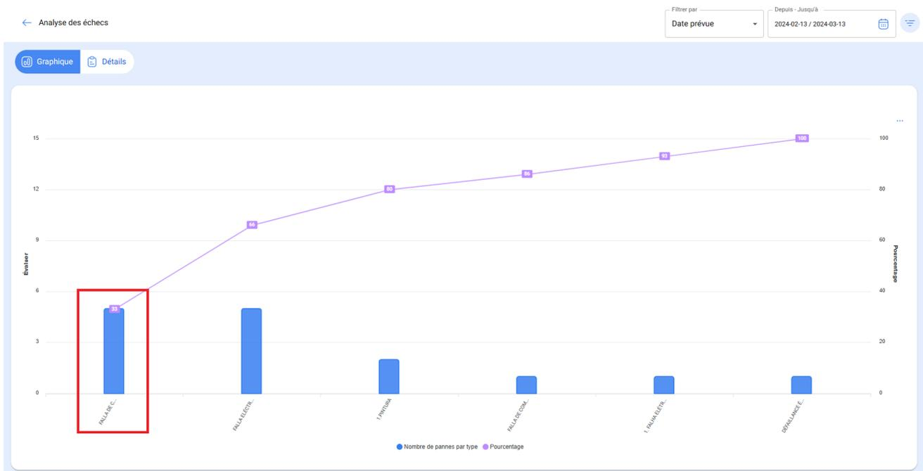
En outre, en cliquant sur les barres du graphique, une nouvelle fenêtre s'ouvrira avec un second diagramme de Pareto associé aux causes à l'origine de la défaillance.
