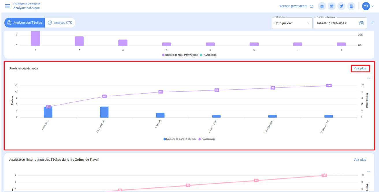
Dans ce module, tous les défauts enregistrés dans le système peuvent être analysés à l'aide d'un diagramme de Pareto, qui permet de classer graphiquement les types de défauts en pourcentage et sous forme numérique, afin de mettre en évidence ceux qui ont le plus d'impact sur la gestion des actifs.
